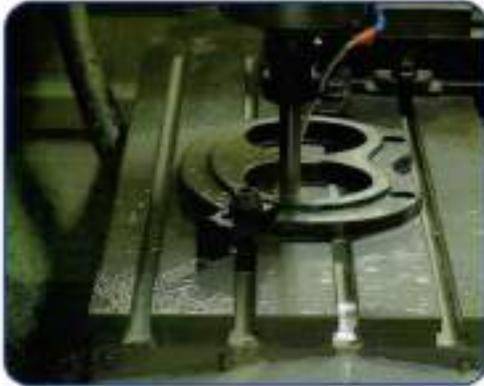
Fabricación y reparación de anillos de corte, placa gafa y placa espejo para bombas de concreto.
