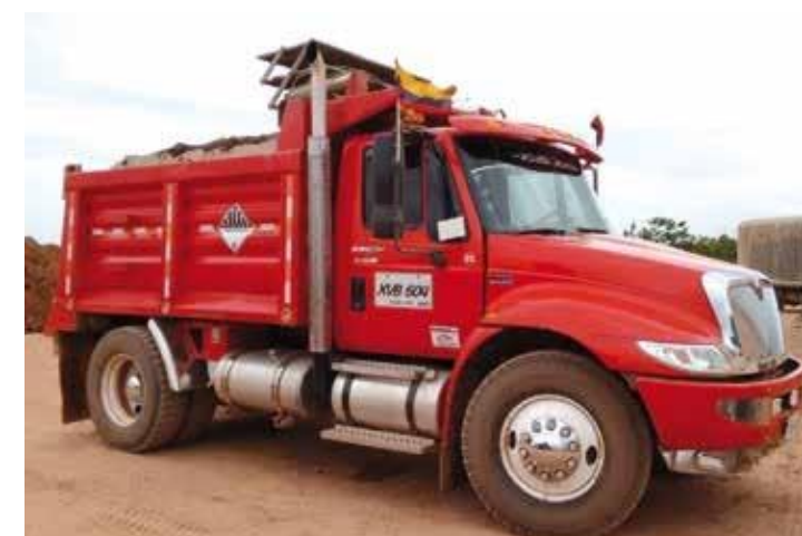
Volqueta doble cabina 6 M3,
