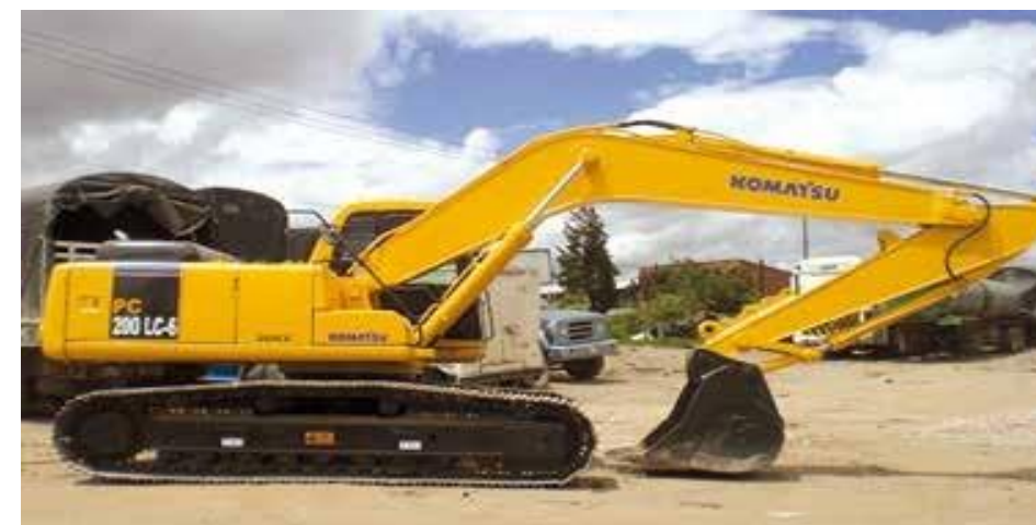
Retroexcavadora sobre oruga Komatsu PC-200
