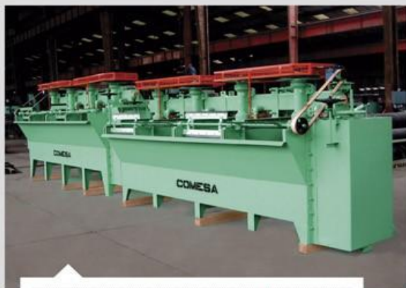
CELDA DE FLOTACIÓN
