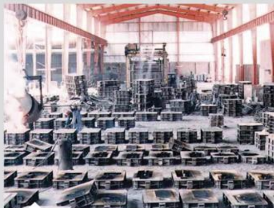
Parte del edificio de colado, de 20 m x 134 m. Al fondo, al centro, un horno de tratamiento térmico.
