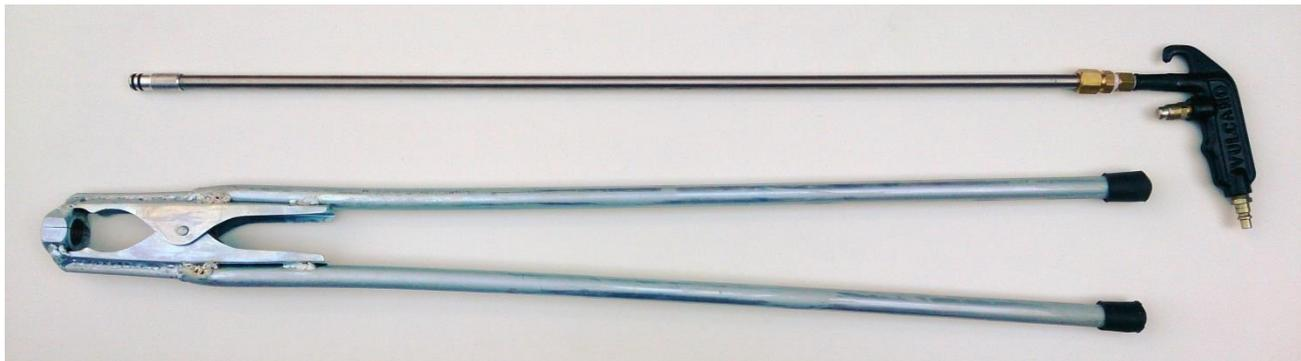
**Fig 5,6,7y 8 - Vista inferior donde se observa un tetón roscado con pasaje de aire, lugar donde se aplica aire comprimido para su desmolde. Acto seguido se emplea la "pinza tuerca" para retirar el casetón.**
