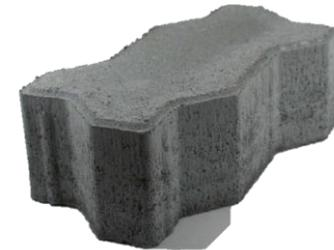
Los adoquines de concreto son elementos prefabricados macizos, elaborados con una mezcla de arena, piedra, agua y cemento a través de un proceso industrial de vibro-compresión en moldes. Las formas y colores de estos productos pueden ser muy diferentes; se utilizan como capa de rodadura en todo tipo de pavimentos (desde patios y veredas hasta pistas de aterrizaje en aeropuertos).
