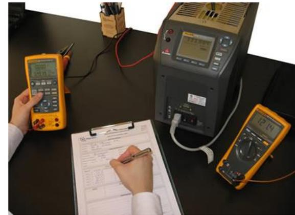
Calibración de aparatos de medición
