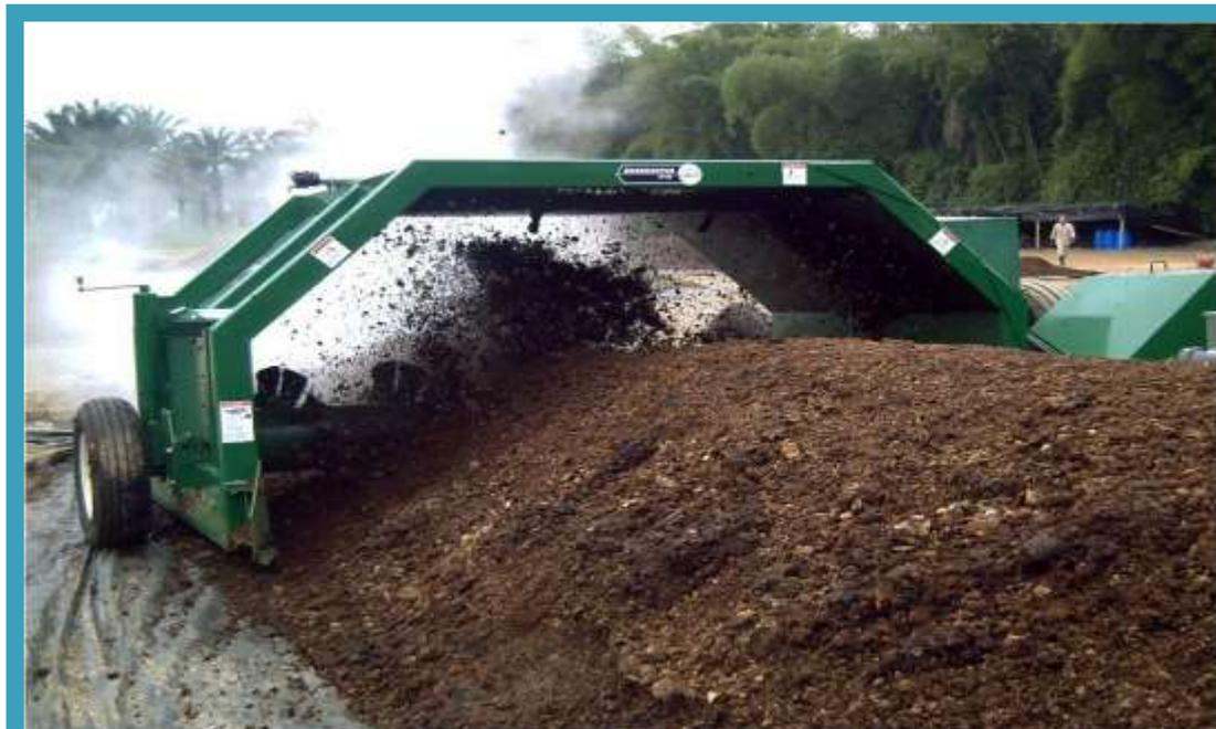
**PLANTA DE PRODUCCIÓN DE ABONOS ORGÁNICOS SÓLIDOS MINERALIZADOS Y LÍQUIDOS CON NITRÓGENO ESTABILIZADO. PROCESO DE COMPOSTAJE AERÓBICO**
