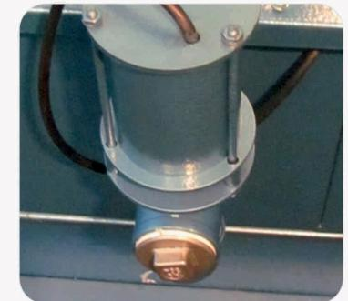
Válvulas solenoides de agua fría y caliente, para los dispensadores y válvula eléctrica para el desagüe. Hacen que la máquina adquiera un sentido ecológico, ya que solo utiliza el agua necesaria para cada lavado evitando que esta se desperdicie.
