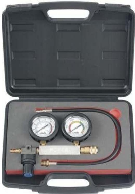
Medidores de porcentajes de PSI y BAR Manguera extra-larga de 660mm (26") Permite diagnosticar en forma exacta problemas del motor, tales como válvulas defectuosas , anillos gastados, paredes del cilindro agrietadas, empaques soplados Cuenta con adaptadores de 14 y 18mm para la mayoría de motores.
