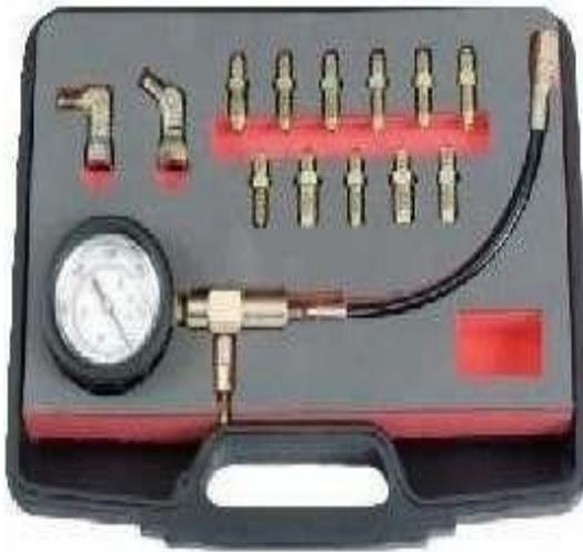
Verifica el estado de sistema de frenos y clutch detectando fugas internas en tubos, bombas, manguetas, orrings, sellos.
