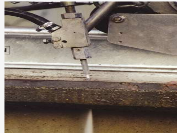
CORTE A FRIO DE UMA CHAPA DE AÇO.
