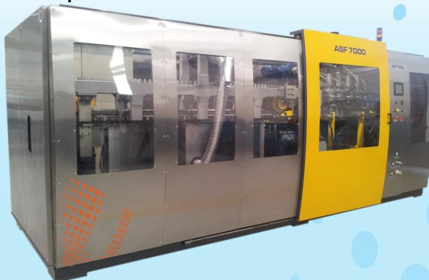
Máquina de sopro/estiramento linear modelo **ASF 7000** para fabricação de garrafas a partir de pré-formas.
