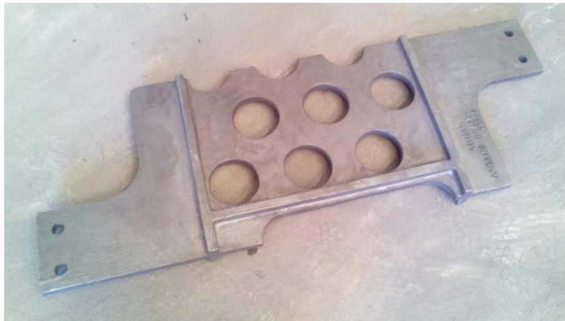
16. 365007_CABEZAL 220 U7. Peso neto: 30 Kg. Material: ASTM A217 C12.-
