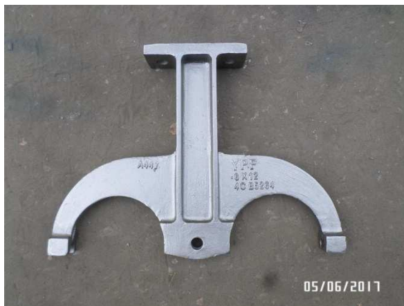
76. 786073_ GUIDE BASE - SOPORTE TUBO PL. 12-W5-04Z-FD14 / BA-601 CILP Material: ASTM A 447 CLASE 25-12 TIPO II Peso: 13,8 Kg.
