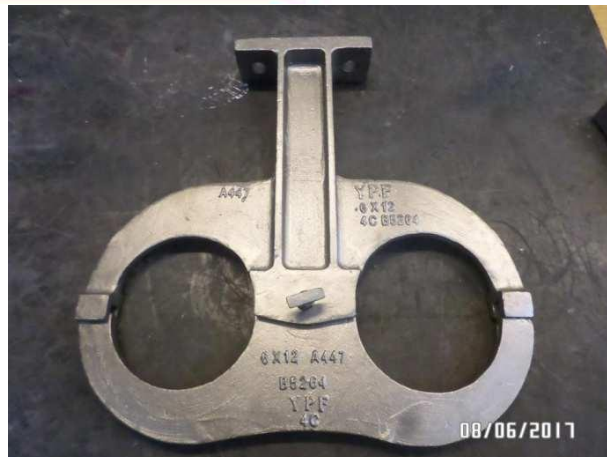
76. 786073_ GUIDE BASE - SOPORTE TUBO PL. 12-W5-04Z-FD14 / BA-601 CILP Material: ASTM A 447 CLASE 25-12 TIPO II Peso: 13,8 Kg.
