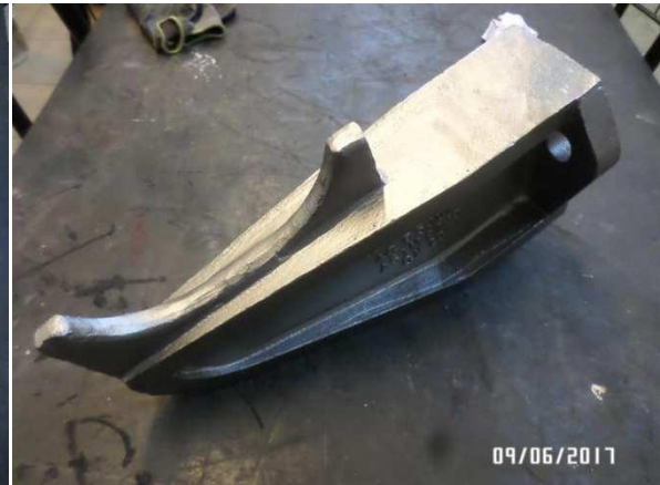
79. 786070_TUBE SUPPORT CASTING 6" S/PL 562-05A REV 0 - COD 233847 Peso neto: 31,5 Kg. Material: ASTM A560 GR. R 20501.-
