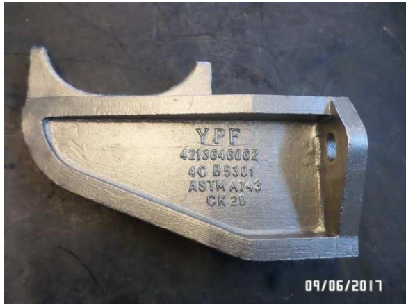
79. 786070_TUBE SUPPORT CASTING 6" S/PL 562-05A REV 0 - COD 233847 Peso neto: 31,5 Kg. Material: ASTM A560 GR. R 20501.-
