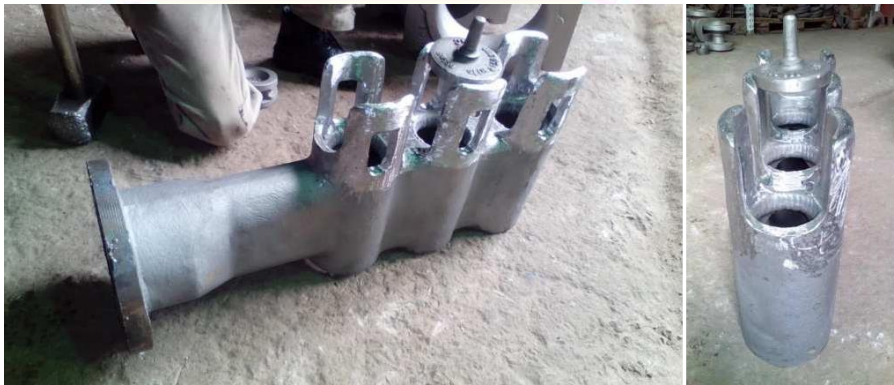
15. 365006_PLACA SOPORTE (PATT N° H-19881) S/PL. 85515-PL-M-017 REV. E. Peso neto: 50 Kg. Material: ASTM A297 HH
