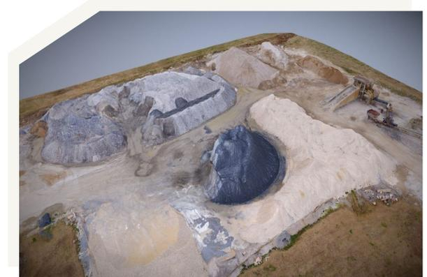
Con las imágenes capturadas se alimenta una plataforma de análisis de datos para su procesamiento. El producto final sería una tabla de cálculos de volumen y un modelo tridimensional medible.
