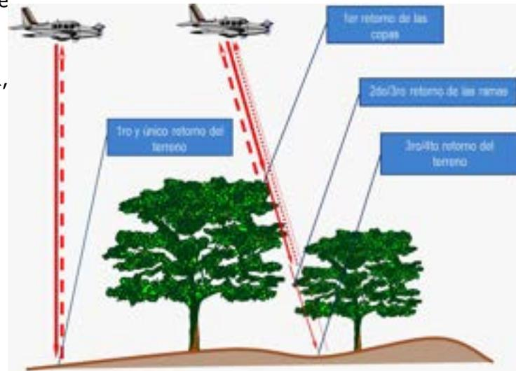
Tecnología LIDAR para TOPOGRAFÍA DE ALTA PRECISIÓN
