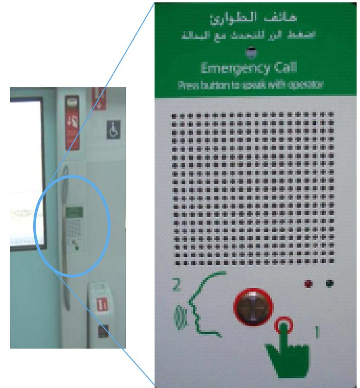
**El AMT5-ECB-A es el dispositivo de intercomunicación a través del cual un conductor o por medio de la radio del tren, un operador de control central o un operador del centro de emergencia pueden tener una comunicación bidireccional con los pasajeros**
