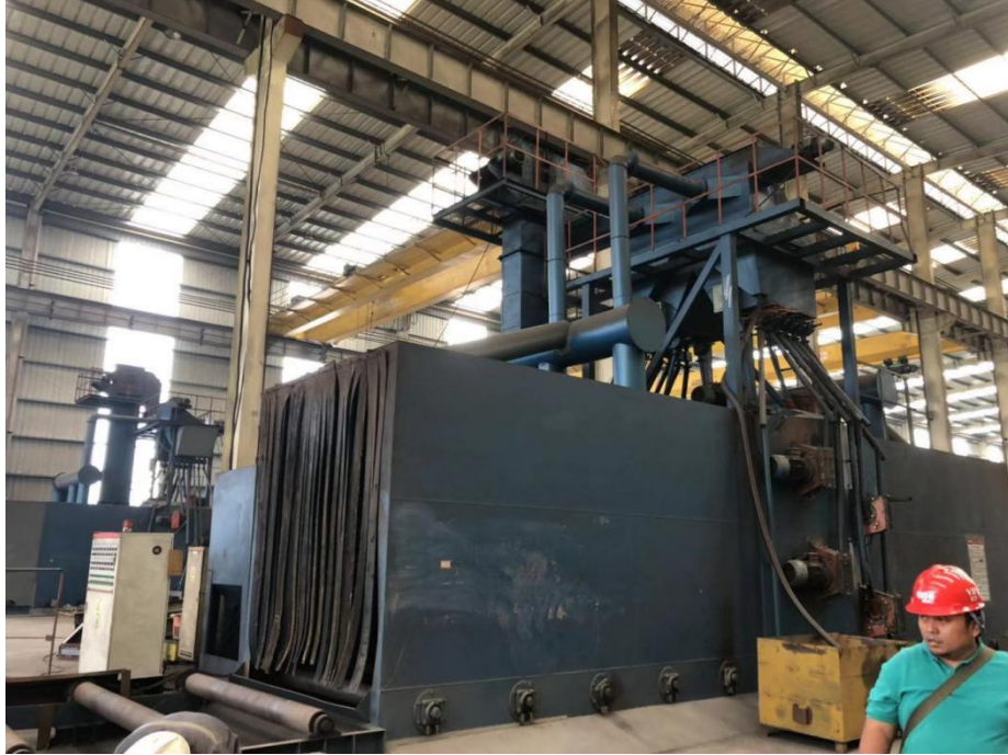
2.5m×3m 全自动抛丸机 2.5m × 3M automatic shot blasting machine
