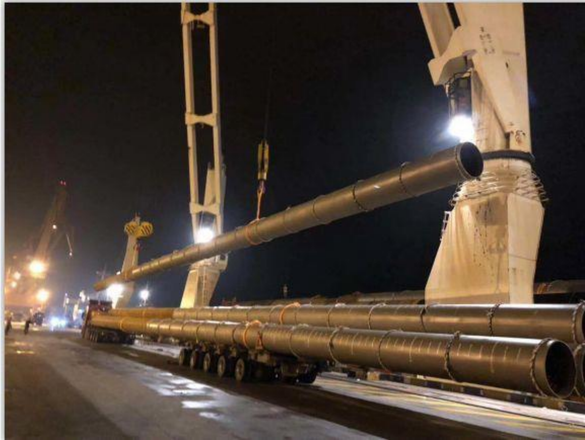
加拿大温哥华项目 500 吨 2018 年 10 月 15 日完成 主要规格: 2750/3050×44.5/38.1×27M/35M Vancouver Project (Canada) 500ton Completed in 15 th Oct. 2018. Main specification: 2750/3050×44.5/38.1×27M/35M
