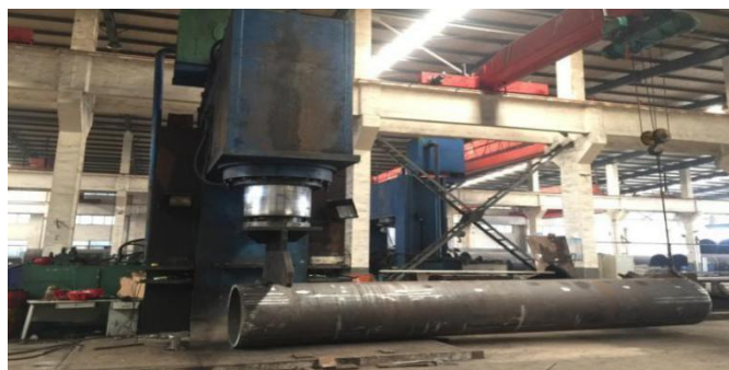
3600 吨虎口液压机（厚壁管整圆、锥管成型）
