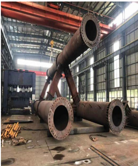
匈牙利广告塔项目 200 吨 2019 年 7 月完成 主要规格: 1600*30*8.7M. Hungarian advertising tower project. 200t. Completed in July 2019. Main specification: 1600 * 30 * 8.7m.
