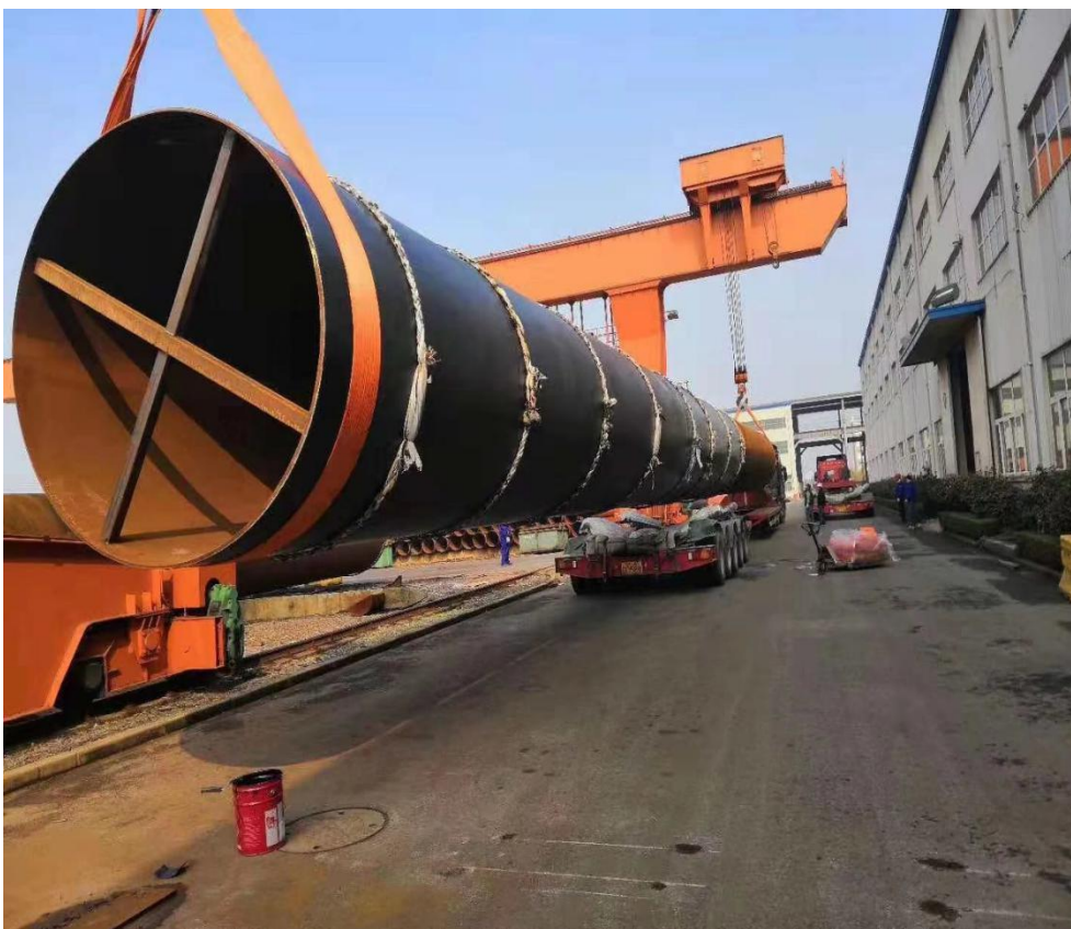
美国项目 1500 吨 2018 年 10 月 15 日完成 主要规格: 2438.4 \times 25 \times 36\text{M}/27\text{M} American Project 1500ton Completed in 15 th Oct. 2018. Main specification: 2438.4 \times 25 \times 35\text{M}/27\text{M}
